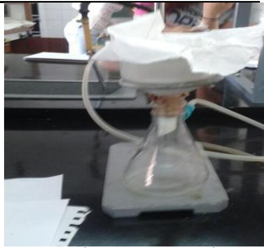
FOTOGRAFÍA No. 31 FILTRACIÓN DEL VINO CLARIFICADO
