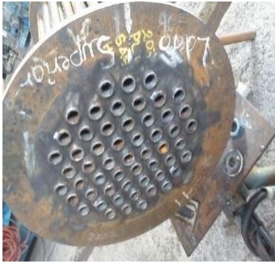
Figura 60 Acabado de tubos de fuego
