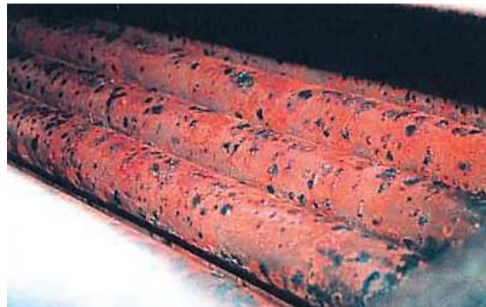
Figura 10. Ataque por picado del oxígeno
