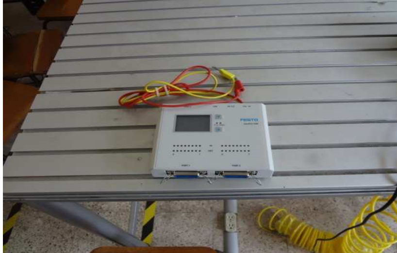
Figura 15. EasyPort cables de alimentación
