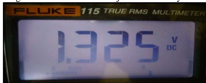
Figura 101. Medida de voltaje entre la base y tierra
