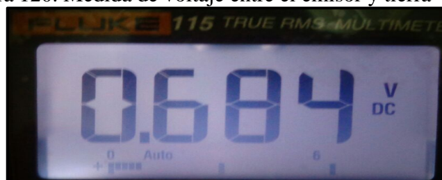
Figura 120. Medida de voltaje entre el emisor y tierra
