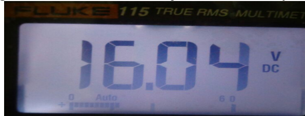
Figura 121. Medida de voltaje entre colector y tierra
