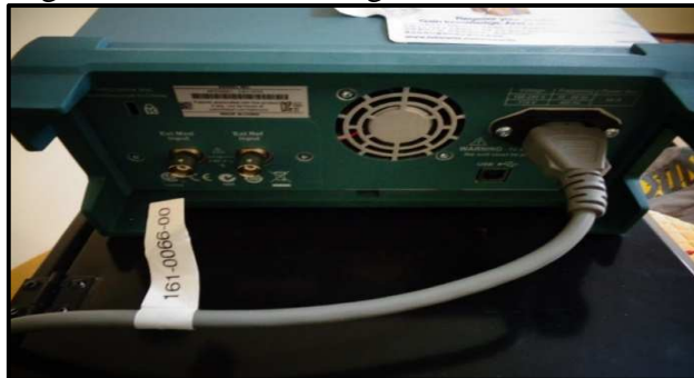
Figura 85. Conexión del generador de funciones
