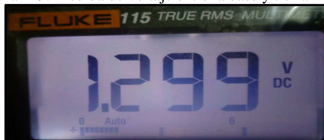
Figura 119. Medida de voltaje entre la base y tierra
