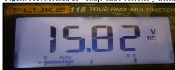
Figura 103. Medida de voltaje entre colector y tierra
