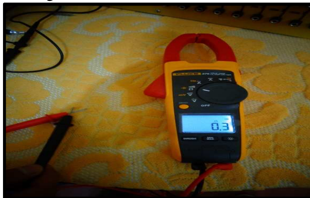
Figura 90. Verificación de continuidad
