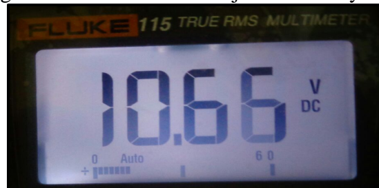
Figura 110. Medida de voltaje entre base y tierra
