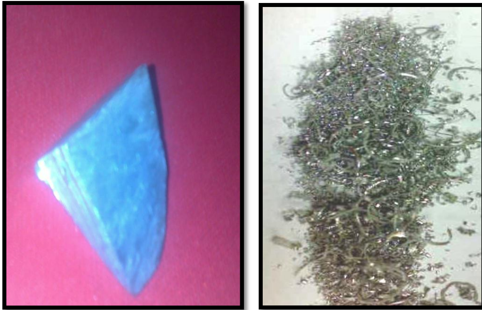
Figura 42. Fracturas de cuñas y desbaste de viruta del babbitt.
