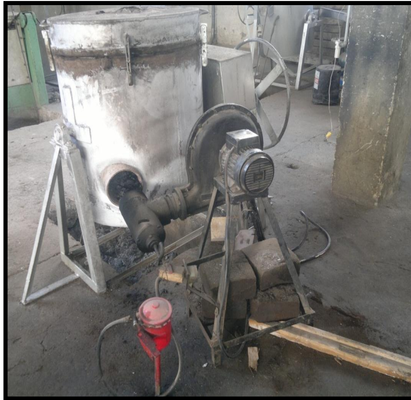
Figura 16. Horno de fundición del Taller de Mecánica
