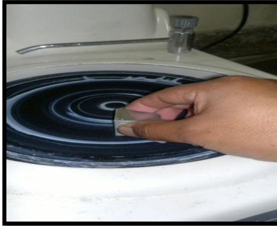
Figura 31. Pulido de probetas
