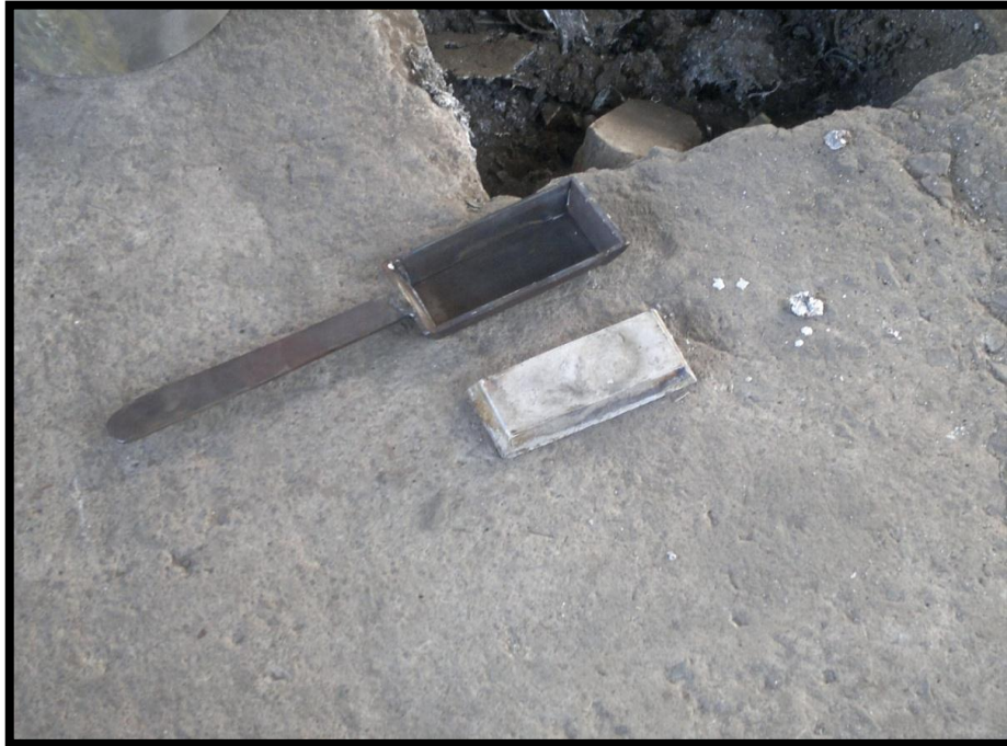
Figura 21. Lingote de Babbitt fundido
