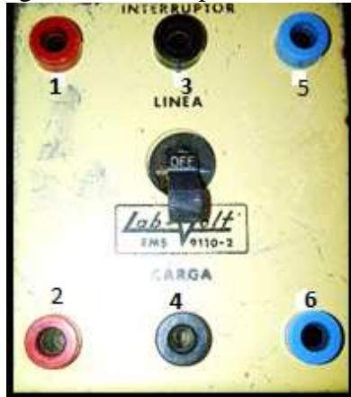
Figura 65. Interruptor de circuito
