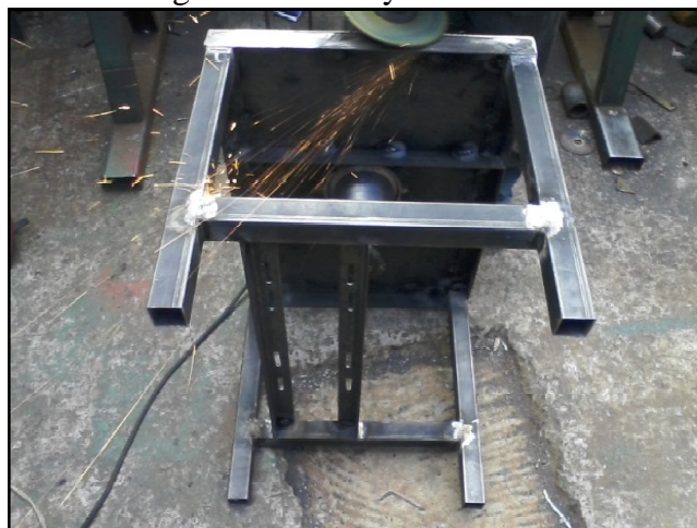
Figura 22. Corte y esmerilado.
