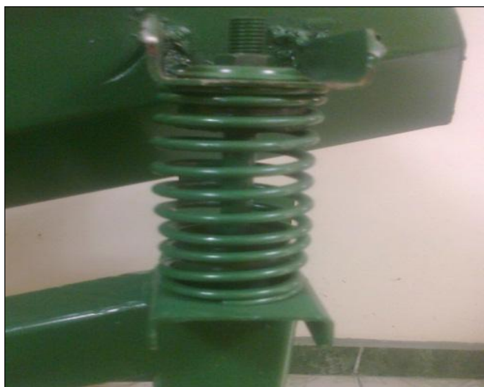
Figura 38. Ensamble de muelle y barra estabilizadora
