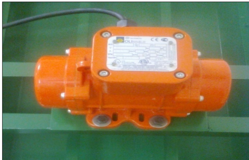
Figura 41. Montaje del motovibrador
