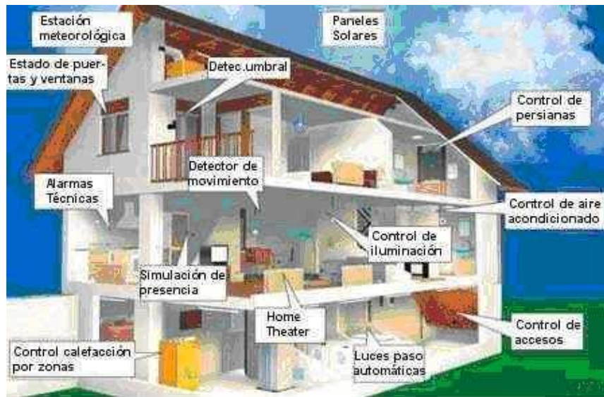
Figura II.1. Aplicaciones típicas de un sistema domótico
