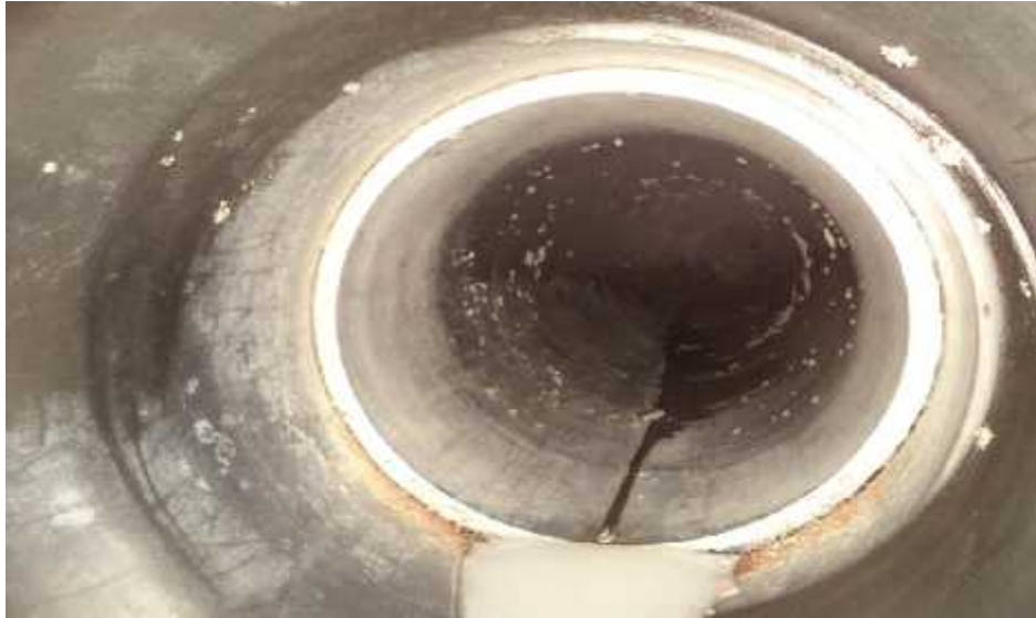
Fotografía 6. Tubería sin presencia de biofilm-Resultados de prueba ensayo Fuente Oxidante y Fuente Preservante INTEROX
