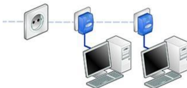
Figura: Conectar dos ordenadores en red a través de la red eléctrica
