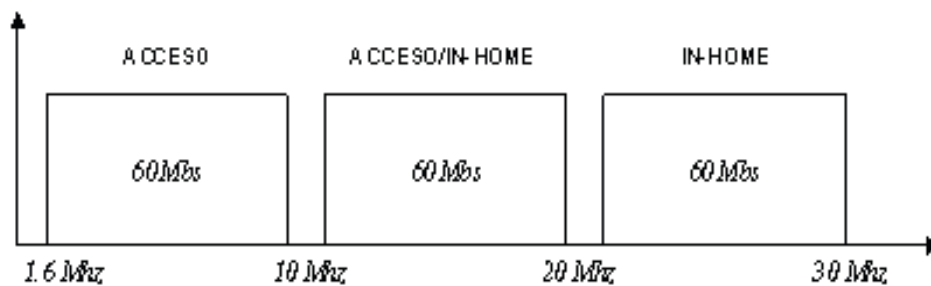
Figura II: 16 Bandas de frecuencias utilizadas en PLC
