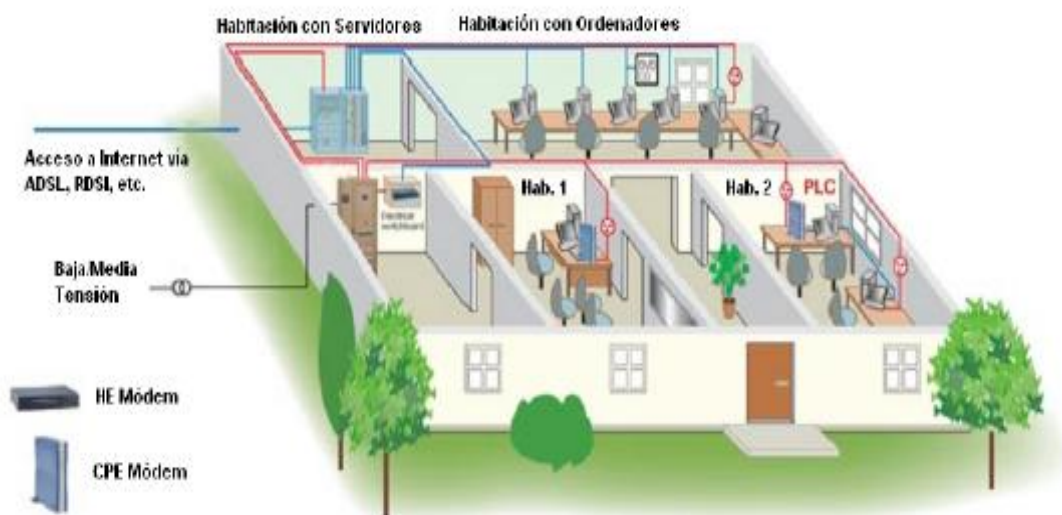
Figura: Topología de la red eléctrica
