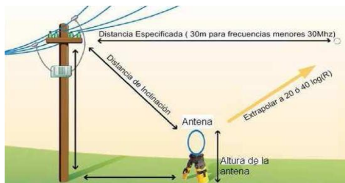
Figura II: 40 Esquema de mediciones de interferencias
