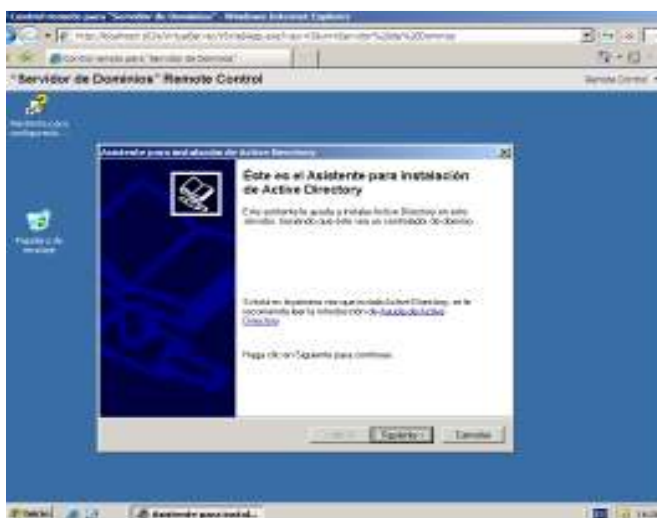
Figura 116: Asistente para instalación de Active Directory
