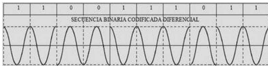
Figura N° 2.33 Codificación por fase en DBPSK
