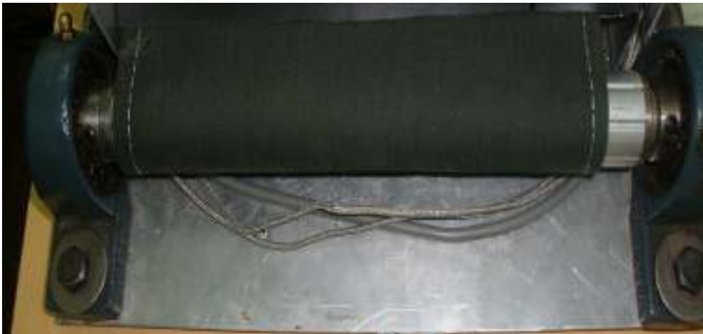
Figura N° IV.2. Banda de lona, chumaceras y rodillos.
