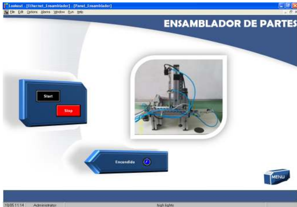
Figura N° 4. Interfaz Ensamblador de Piezas
