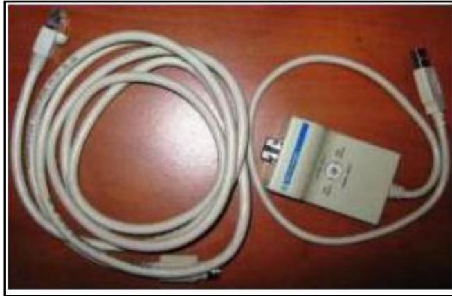
Figura IV. 116 Cable multimaestro. <sup>129</sup>
