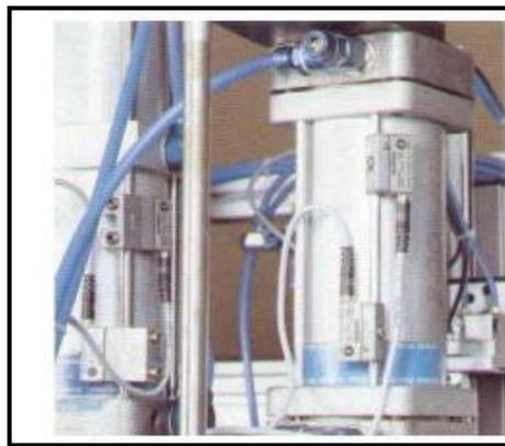
*Figura II. 4 Detector Reed insertado en el cilindro neumático. <sup>4</sup>*
