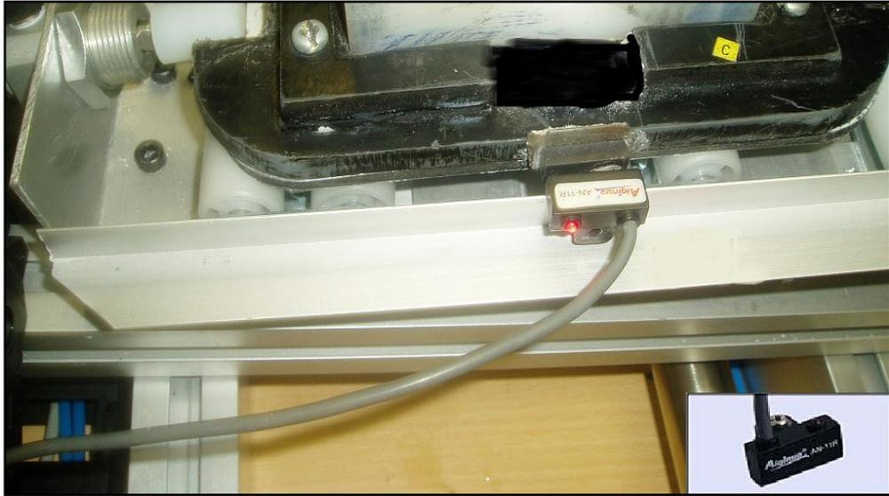
Figura IV. 72 Sensor Magnético AN-11R <sup>75</sup>
