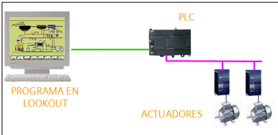
Figura IV. 120 Componentes de un Sistema Scada. <sup>133</sup>
