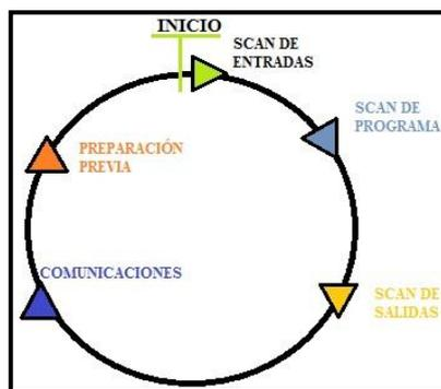
Figura III. 50 Ciclo de operación de un PLC.<sup>53</sup>
