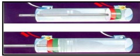
*Figura II. 5 Principio de Funcionamiento del Sensor Magnético .<sup>5</sup>*
