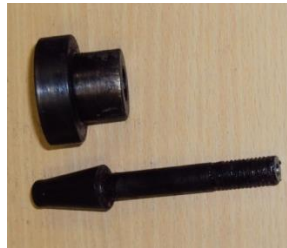
Figura III. 40 CONSTRUCCIÓN DE LAS PARTES DE LA BOQUILLA DEL CABEZAL
