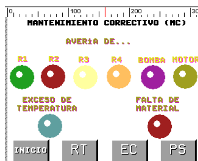
Figura IV. 6 PANTALLA DE MANTENIMIENTO CORRECTIVO DEL HMI
