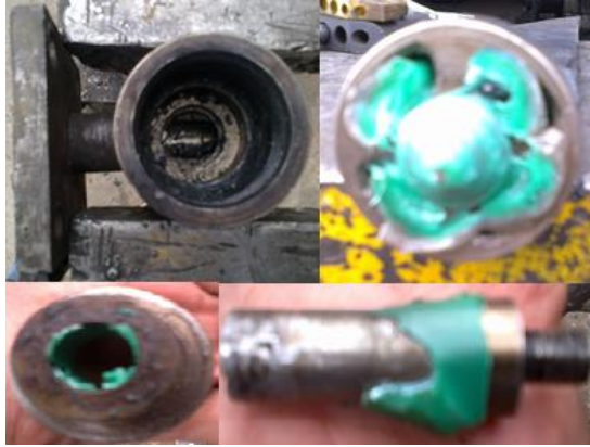
Figura III. 37 PIEZAS DE LA EXTRUSORA CON RESTOS DE PLÁSTICO DURO
