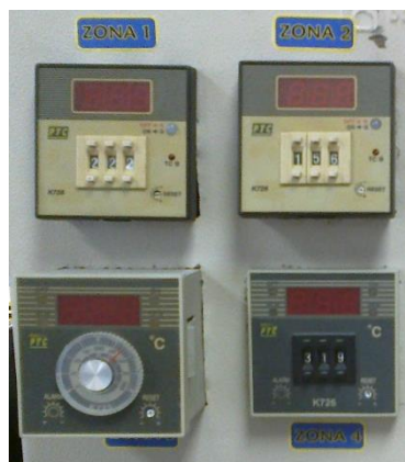
Figura III. 25 TERMOREGULADORES ANALÓGICOS Y DIGITALES DEL SISTEMA ANTERIOR
