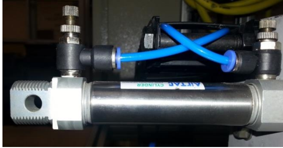
Figura III. 12 IMPLEMENTACIÓN DE RACORES Y REGULADORES DE CAUDAL EN LOS CILINDROS
