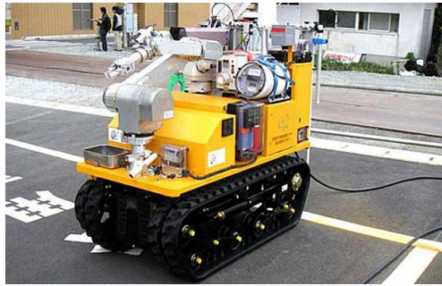
Figura II -6 Robot blindado en la planta nuclear de Fukushima
