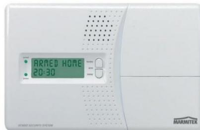
*Figura III 21 Controlador telefónico X10*
