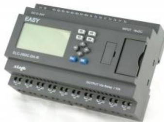
Figura II 8 Controlador Lógico Programable PLC
