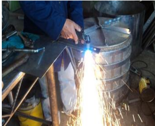
Figura 47. Corte de la chapa metálica
