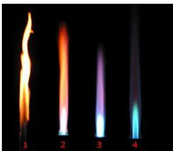
Figura 7. Tipos de llama en un quemador Bunsen dependiendo del flujo de aire.
