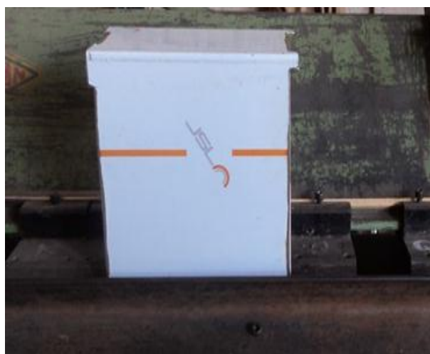
Figura 54. Doblado de la chapa metálica
