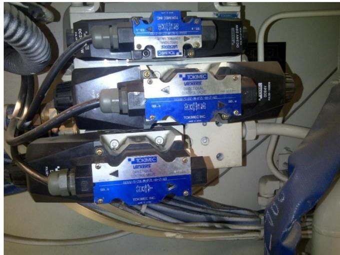
**Figura II. 20:** Válvulas direccionales
