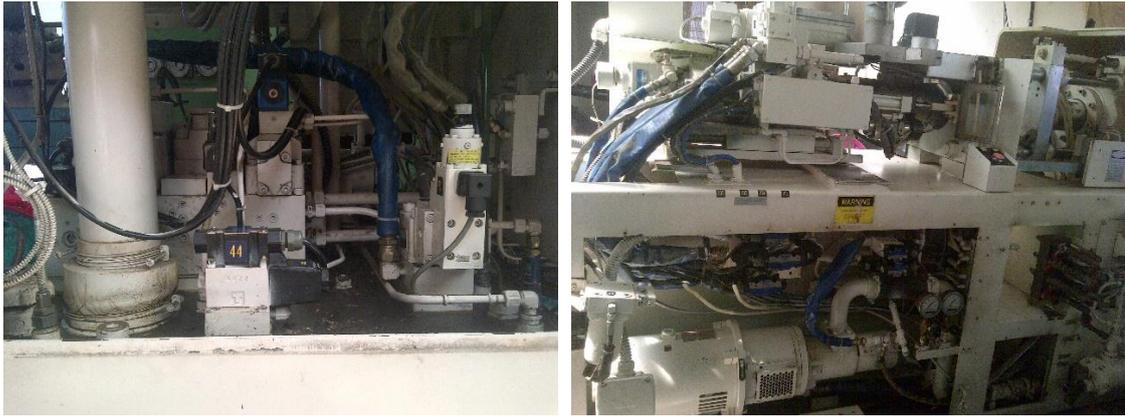
**Figura II. 16:** Circuito Hidráulico Unidad de cierre e inyección
