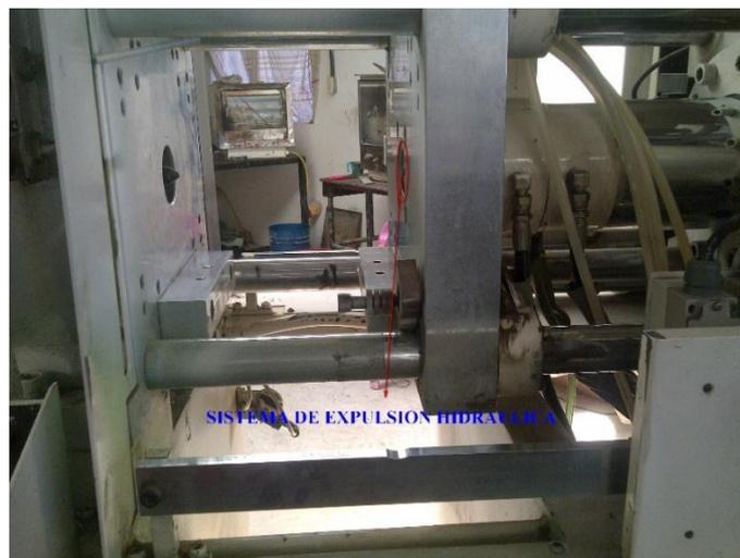
**Figura II. 15:** Expulsor Hidráulico
