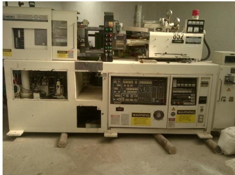
**Figura II. 1:** Maquina inyectora de plástico
