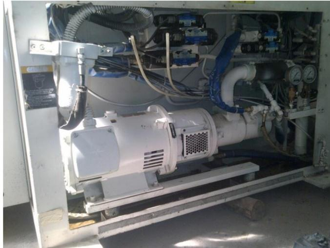
**Figura III. 28:** Unidad hidráulica de una máquina inyectora
