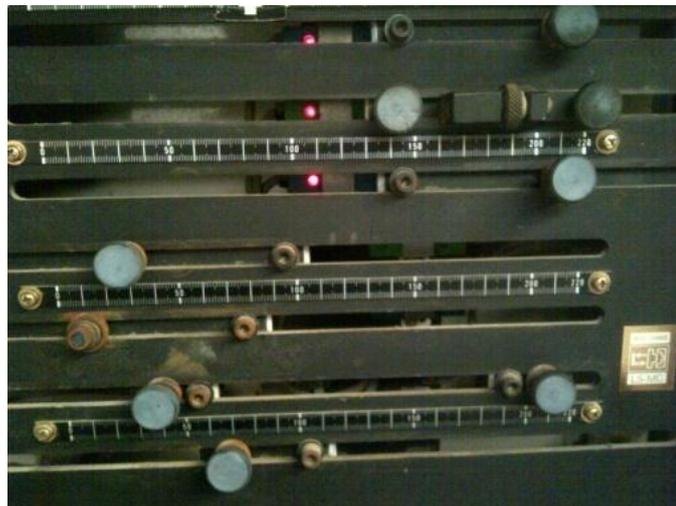
**Figura V. 74:** Identificación de los sensores inductivos
