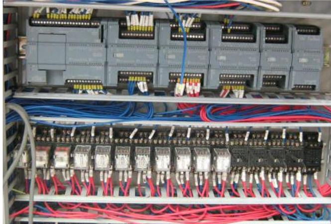
**Figura V. 83:** Conexión de las electroválvulas
