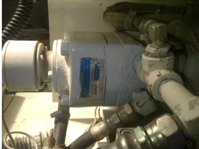
**Figura II. 21:** Motor Hidráulico
