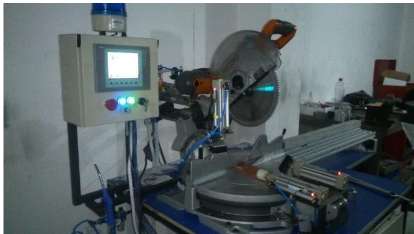
Figura IV-43. Montaje de los soportes y caja de control.
