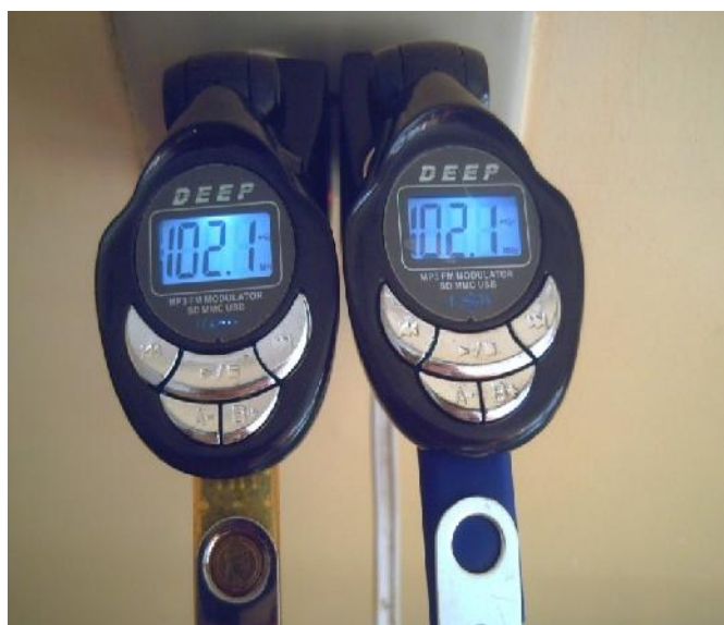
FIGURA IV.3 Transmisores Encendidos para Interferencia Cocanal
