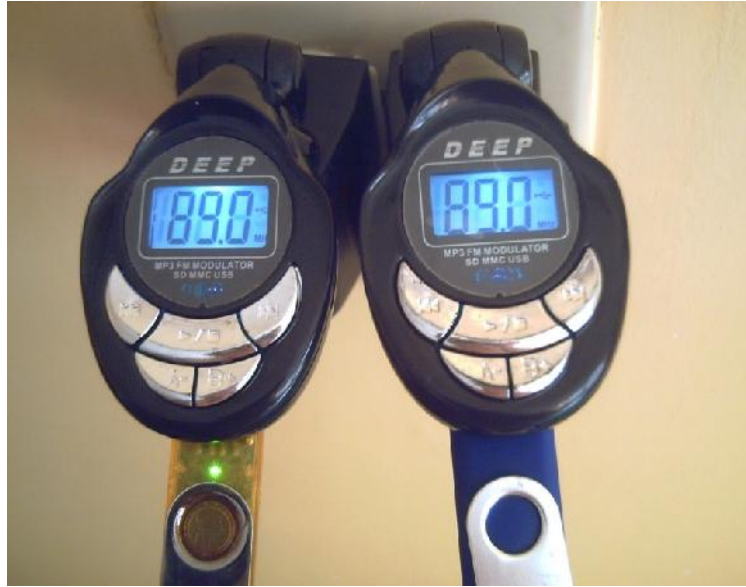
FIGURA IV.9 Transmisores Encendidos para interferencia por Intermodulación Fuente: Darwin Parreño, Alex Logroño (Autores)
