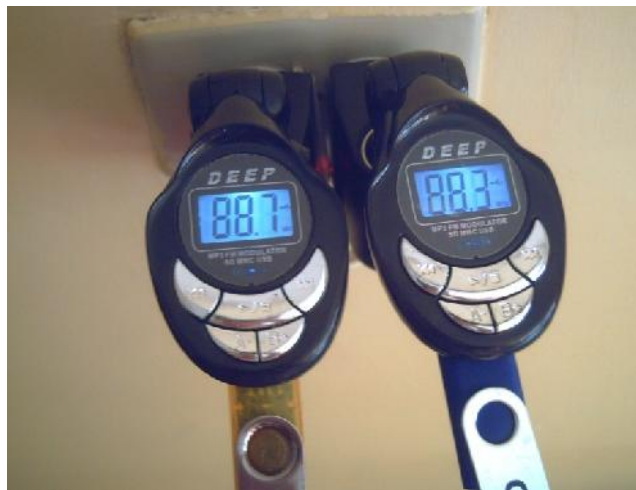
FIGURA IV.6 Transmisores Encendidos para Interferencia Adyacente Fuente: Darwin Parreño, Alex Logroño (Autores)
