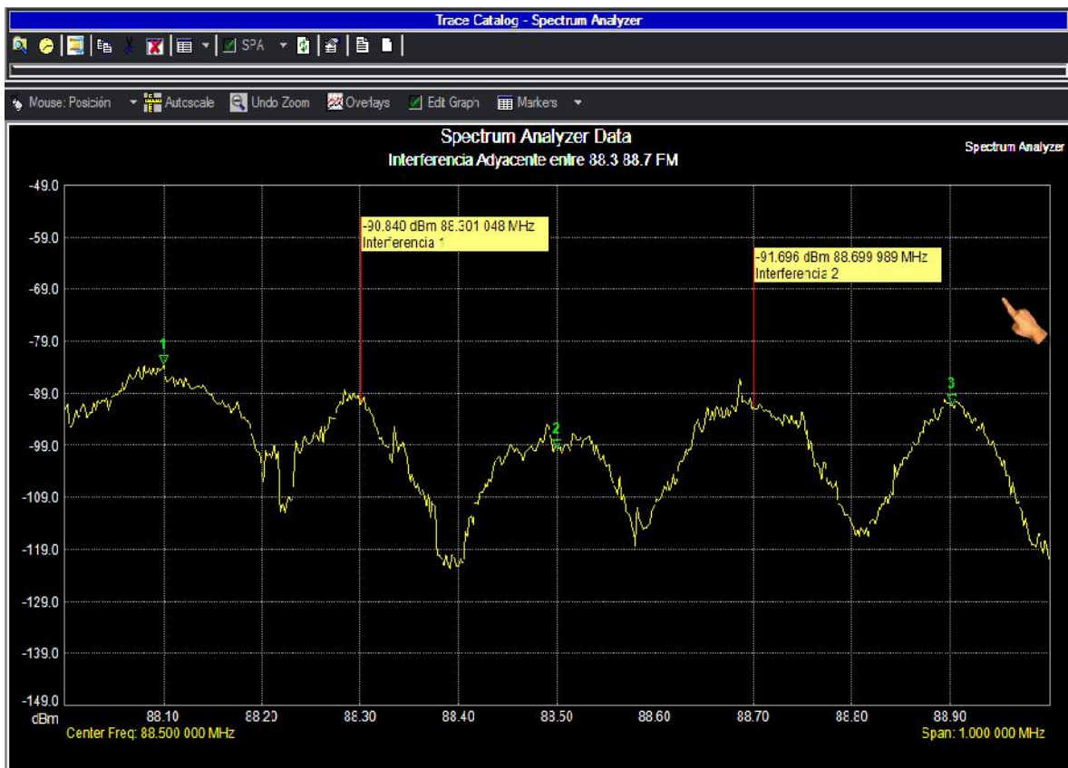
FIGURA IV.8 Pantalla del software Master Tools con Interferencia Adyacente Fuente: Darwin Parreño, Alex Logroño (Autores)
