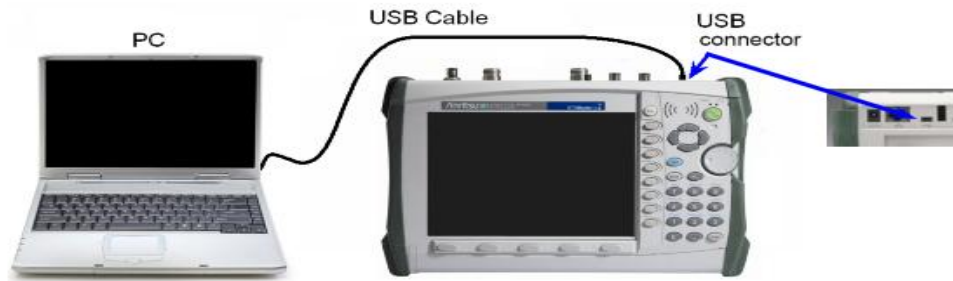
FIGURA III.9 Conexión PC y Analizador de Espectro Anritsu MS2724C Fuente: Master Software Tools User Guide
