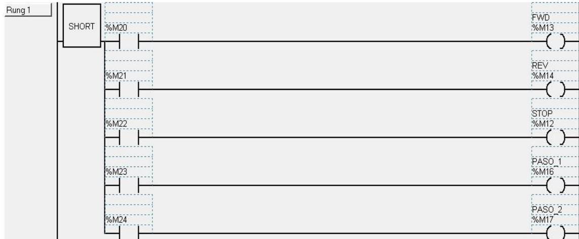
**Figura V.14:** Transferencia de entradas al variador
