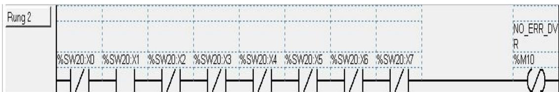
**Figura V.15:** Indicador de fallas de comunicación Drive
