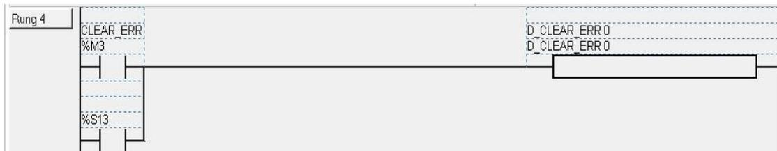
**Figura V.17:** Borrado de errores de comunicación
