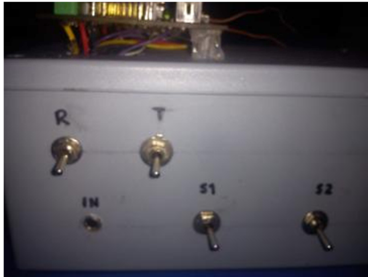
Figura III. 27. Switch de selección de algoritmos de compresión de audio S1 y S2
