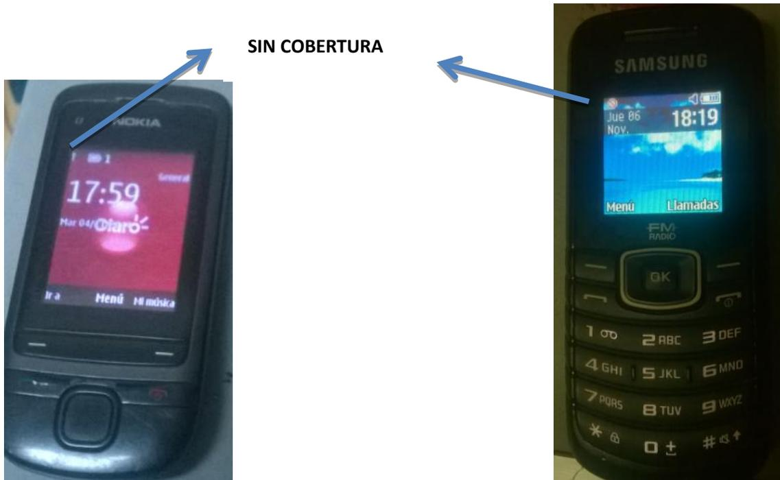
**Figura V.62** Funcionamiento de los Celulares con el Jammer Encendido<sup>81</sup>
