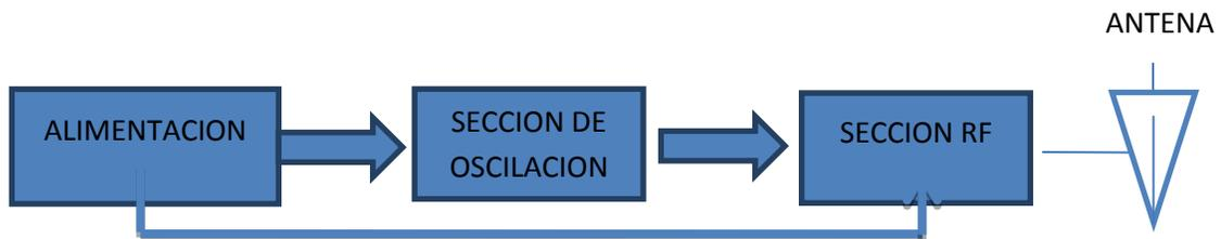
**Figura IV.33** Diagrama de Bloques del Jammer<sup>45</sup>
