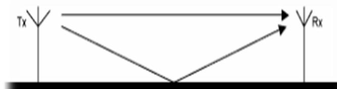
**Figura II.9** Alta inmunidad frente a interferencia de señales multirrayecto<sup>10</sup>
