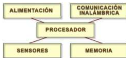
FIGURA II.1 Componentes de un nodo inalámbrico Fuente: dialnet.unirioja.es/download/libro/377564.pdf
