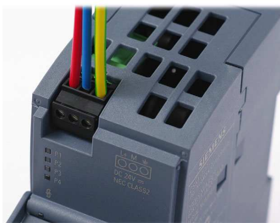
Figura 49. Conexión de alimentación del módulo compact switch.
