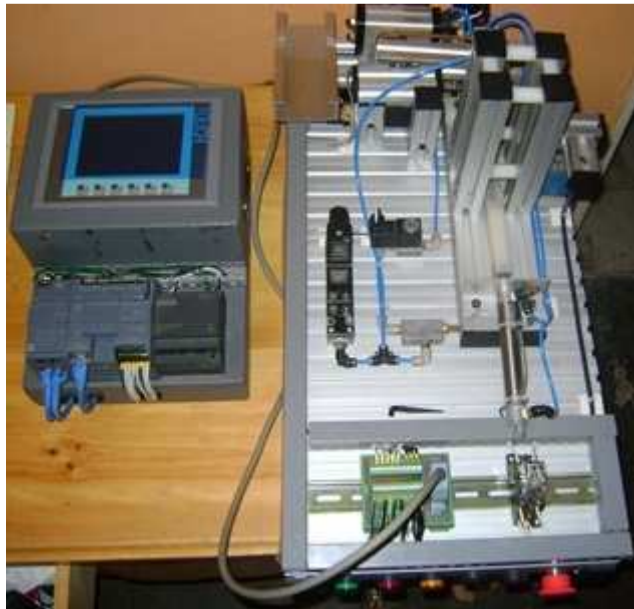
Figura 48. Conexión del módulo de automatización al módulo de transporte
