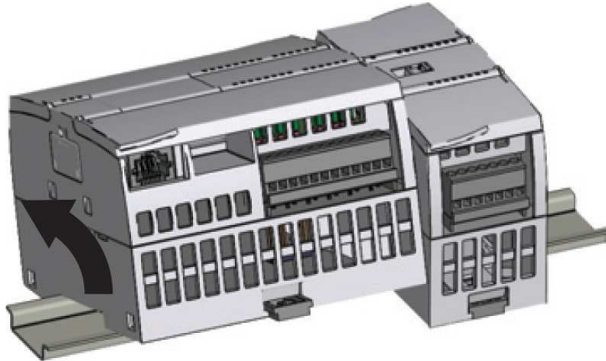
Figura 39. Desmontaje del PLC S7-1200 de un perfil DIN
