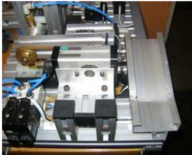
Figura 30. Implementación de la rampa de descarga.
