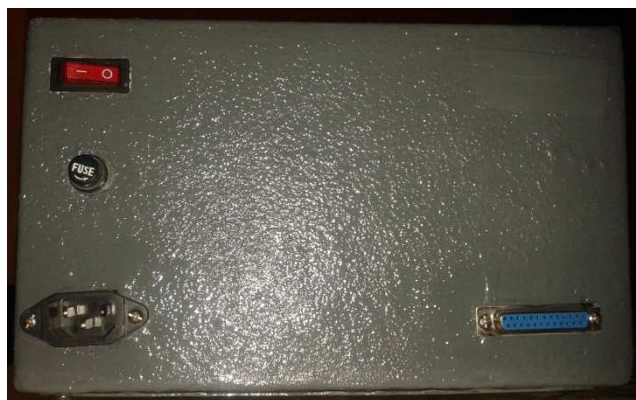
Figura 36. Ubicación de elementos de control y protección
