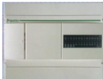
Figura IV-1: Imagen del PLC TWDLCDA24DRF.
