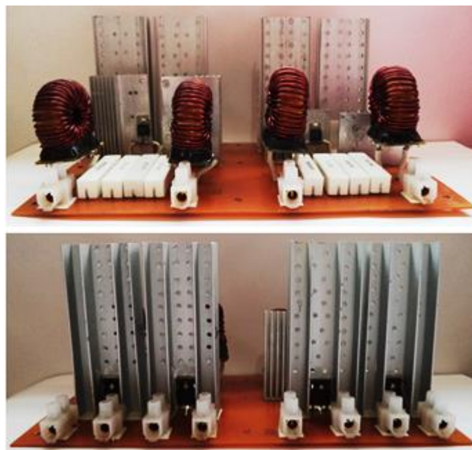
Figura III.12. Placa con los circuitos convertidor resonante implementada (vistas frontal y posterior) Fuente: Realizado por los autores
