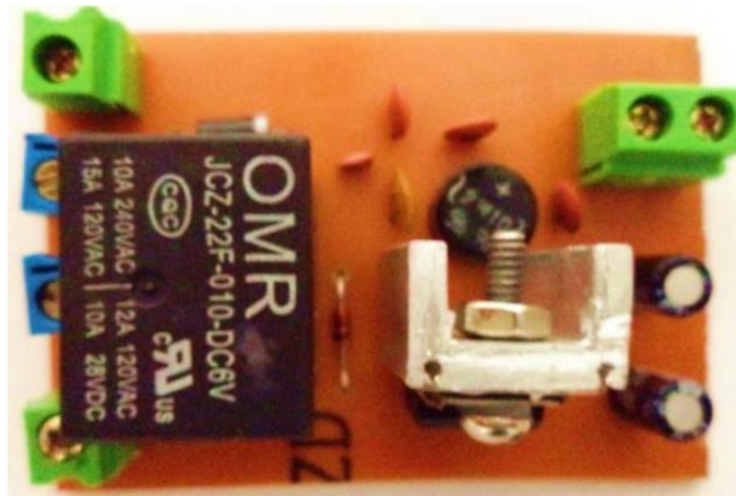
Figura III.30. Placa implementada con el relé electromecánico Fuente: Realizado por los autores
