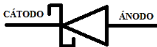
Figura II.28. Símbolo de un diodo Schottky Fuente: Realizado por los autores
