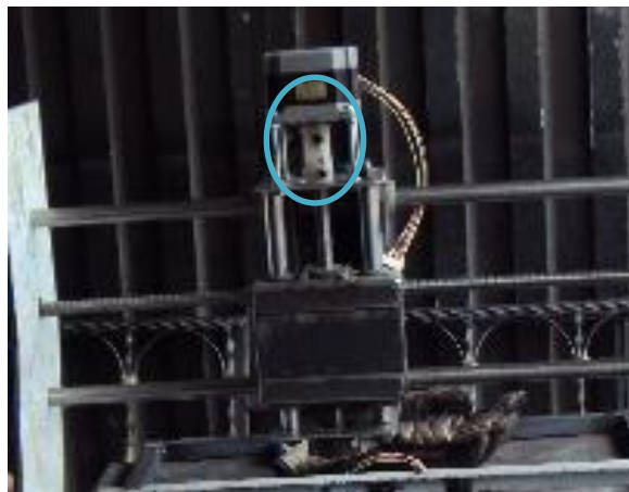
Figura III.33: Sistema de acople del Tornillo sin fin y el Motor PAP
