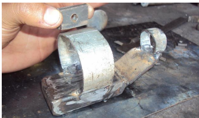
Figura III.34: Proceso de armado del Portaherramienta
