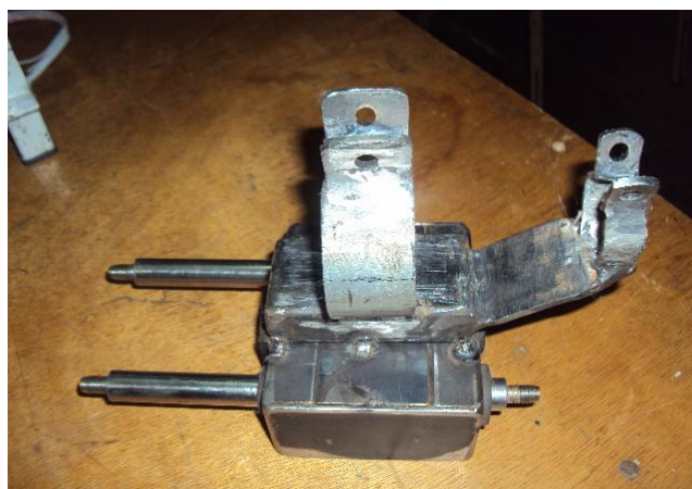
Figura III.36: Portaherramienta acoplado a la base principal del eje Z
