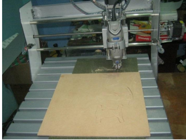
Figura V.10: Mecanizado del diseño en MDF.
