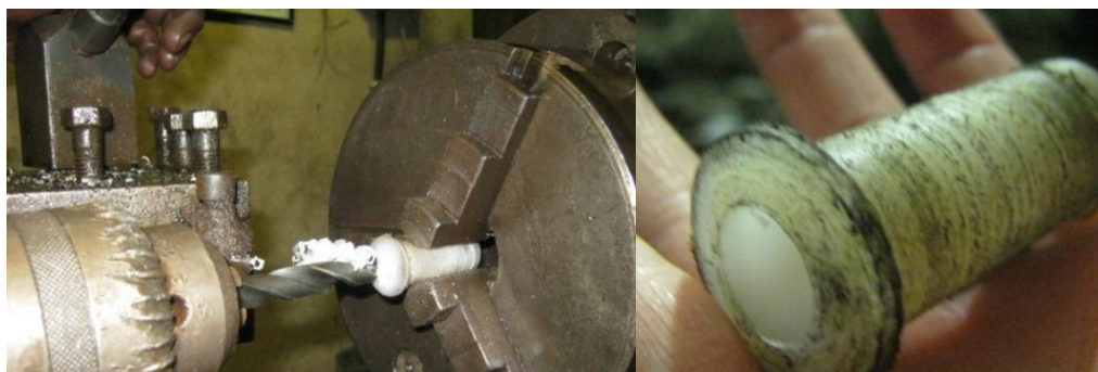
Figura III.16: Construcción de los Bocines.
