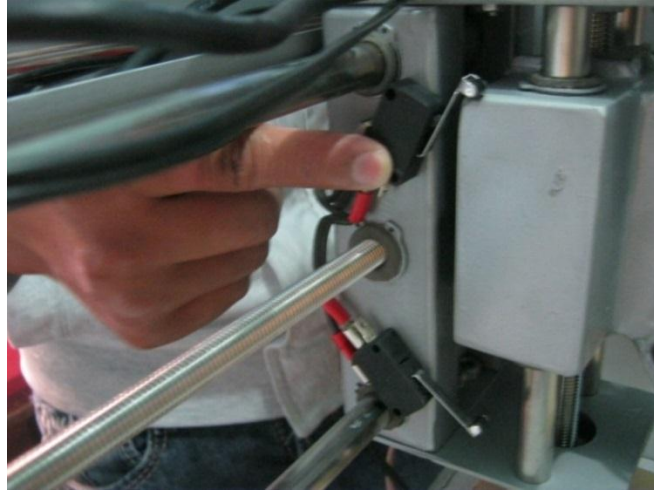
Figura IV.32: Colocación de los Limit switch
