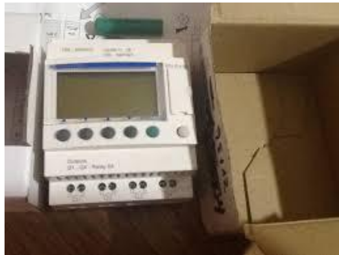
Fuente: Marco Vinicio Correa Castro (Autor) Figura IV. 49. PLC schneider electric / telemecanique sr2 b121fu
