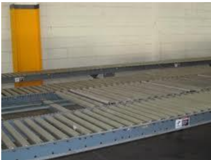
Fuente: http://www.bandascortes.com/familias.php?codF=5&codP=8 Figura II. 31. Banda transportadora accionada por rodillos.
