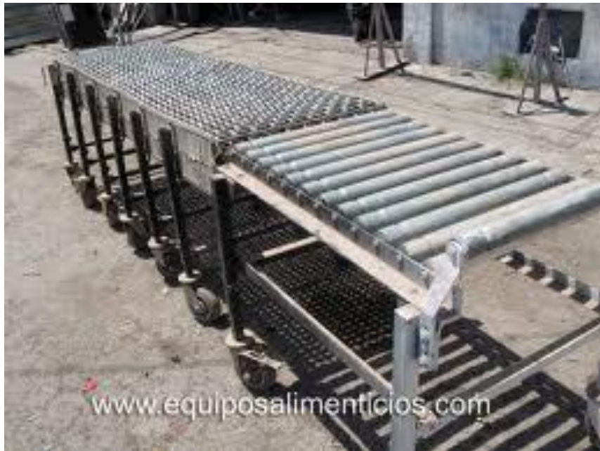
Fuente: http://www.equiposalimenticios.com/inventario/banda-transportadora-marca-best-flex Figura II. 33. Banda transportadora de rodillos de carga
