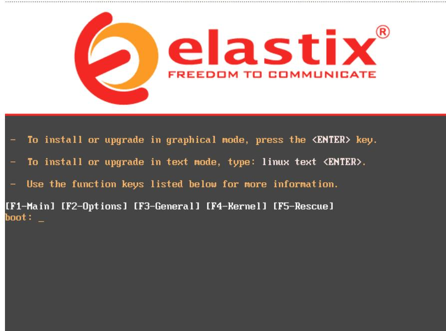
*Figura IV. XII Arrancando la instalación de Elastix*
