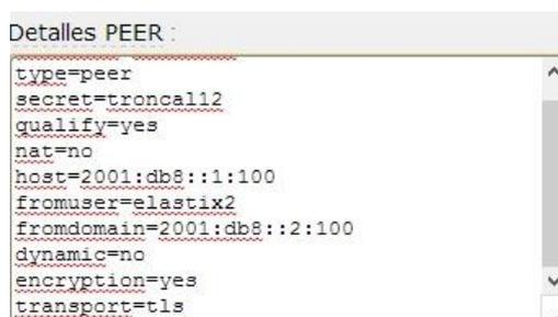
**Figura IV. XXX** Configuración TLS y sRTP en la troncal SIP
