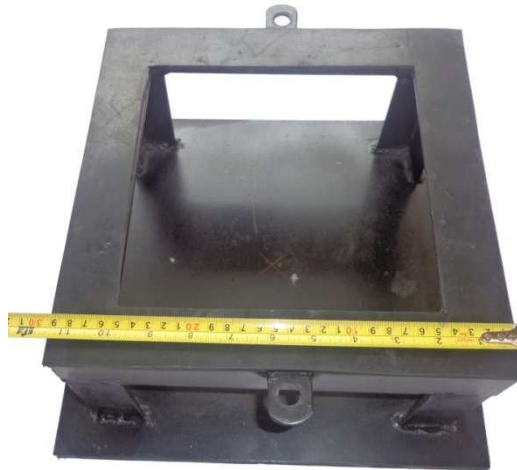
Figura 43. Verificación de las dimensiones principales del soporte
