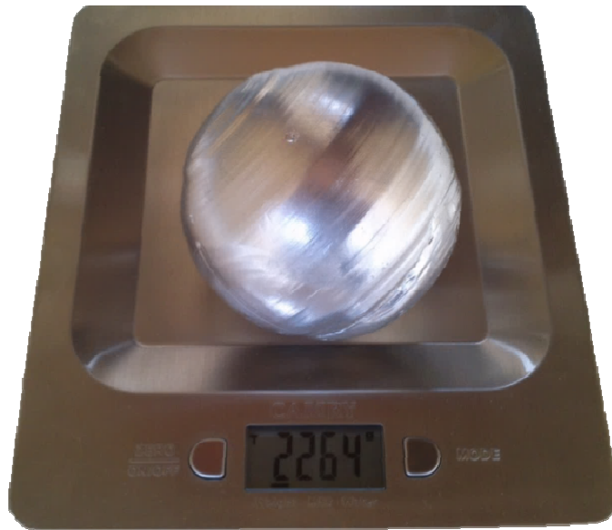
Figura 44. Verificación de la masa de la esfera de acero para vidrio laminado
