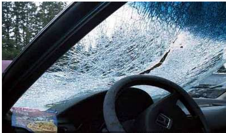
Figura 1. Vidrio de seguridad laminado para automotores
