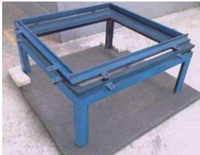
Figura 10. Soporte para ensayo de esferas de acero modificado
