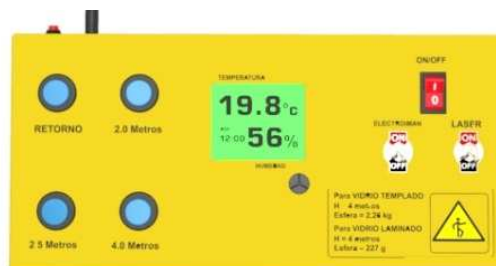
Figura 32. Tablero de control de la torre telescópica
