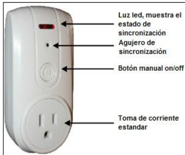
Figura 88. Descripción del sensor “smart plug”
