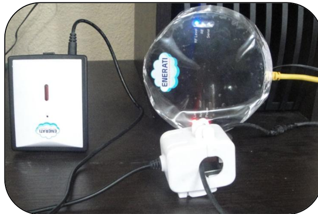
Figura 87. CT Clamp instalado
