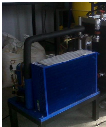
Figura 97. Acople entre condensadora e intercambiador de calor de placas.
