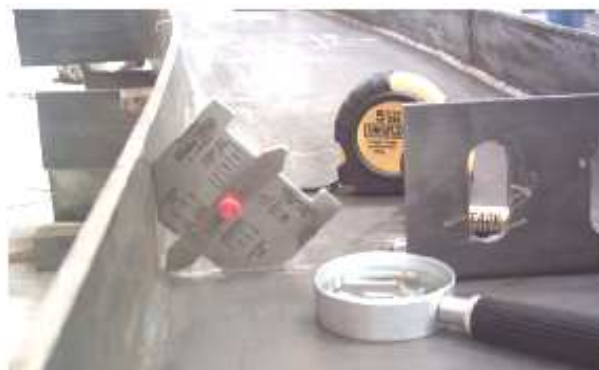
Figura 20. Instrumentos utilizados en inspección visual de soldadura
