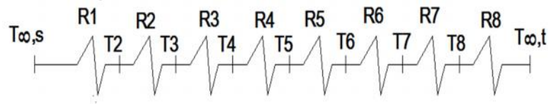
Figura 57. Circuito térmico pared 4 – sauna
