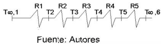
Figura 43. Circuito térmico del piso – turco
