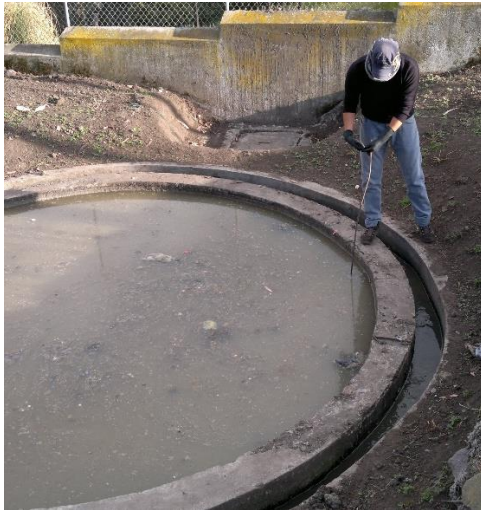
b.) Comprobación mediante sonda de la profundidad del filtro anaerobio.
