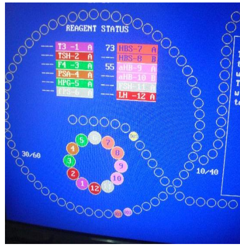
FOTOGRAFÍA No. 19. CARGA DE LOS VIALES DE REACTIVOS AY B EN EL CARRUSEL PARA EJECUTAR EL ENSAYO.
