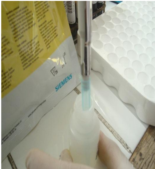
FOTOGRAFÍA No. 16. LAS MUESTRAS SE PRE DILUYEN EN UNA PROPORCIÓN DE 1 POR 21 SE NECESITA 400 µL DE DILUYENTE DE MUESTRA
