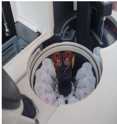
FOTOGRAFÍA No. 8. LAS VIALES SE COLOCA EN EL EQUIPO QUE SON NECESARIAS PARA EL ENSAYO ESTOS REACTIVOS DEBEN ESTAR REFRIGERADOS ESTABLES A 2-8°C
