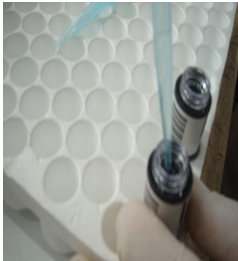
FOTOGRAFÍA No. 16. LAS MUESTRAS SE PRE DILUYEN EN UNA PROPORCIÓN DE 1 POR 21 SE NECESITA 400 µL DE DILUYENTE DE MUESTRA
