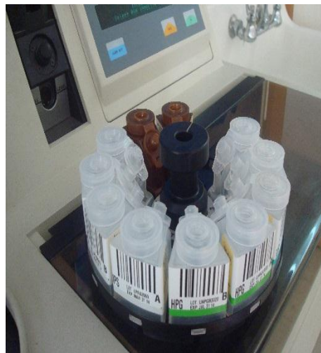
FOTOGRAFÍA No. 8. LAS VIALES SE COLOCA EN EL EQUIPO QUE SON NECESARIAS PARA EL ENSAYO ESTOS REACTIVOS DEBEN ESTAR REFRIGERADOS ESTABLES A 2-8°C
