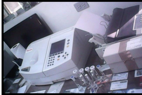
FOTOGRAFÍA No 21. DETERMINACIÓN DE LA CONCENTRACIÓN FINAL DE LOS ALCALOIDES TOTALES EN LA FASE ACUOSO POR ESPECTROSCOPIA DE UV (THERMO ELECTRON HEAIOS, INGLATERRA).
