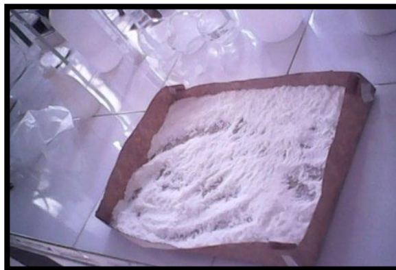
FOTOGRAFÍA No 26. ETAPA DE SECADO EN UNA ESTUFA CON AIRE CALIENTE (BESCHICKUNG-LOADING MODELL 100-800, GER
