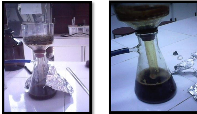
FOTOGRAFÍA No 6. CLARIFICACIÓN DEL EXTRACTO POR FILTRACIÓN AL VACÍO EN EL EQUIPO DE BUCHNER.
