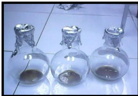
FOTOGRAFÍA No 16. 3 FORMULACIONES DE LAS DISPERSIONES SÓLIDAS ALCALOIDEAS EN UNA RELACIÓN 1:1, 1:2.5 Y 1:5 PREPARADAS MEDIANTE EL MÉTODO DE DISOLUCIÓN UTILIZANDO KOLLIDON K-30® COMO MATRIZ POLIMÉRICA.
