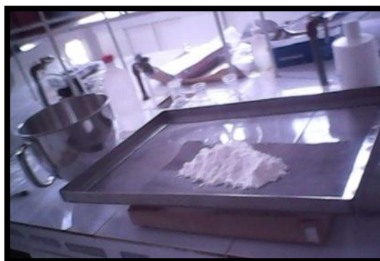
FOTOGRAFÍA No 40. VARIAS FOTOGRAFÍAS DE LOS GRÁNULOS OBTENIDOS MEDIANTE LA APLICACIÓN DE LA TÉCNICA GRANULACIÓN SECA ACTIVADA POR HUMEDAD (MADG MOISTURE ACTIVES DRY GRANULATION).
