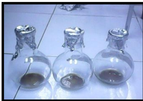
FOTOGRAFÍA No 16. 3 FORMULACIONES DE LAS DISPERSIONES SÓLIDAS ALCALOIDEAS EN UNA RELACIÓN 1:1, 1:2.5 Y 1:5 PREPARADAS MEDIANTE EL MÉTODO DE DISOLUCIÓN UTILIZANDO KOLLIDON K-30® COMO MATRIZ POLIMÉRICA.
