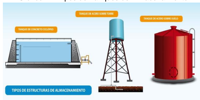
Gráfico 1-4 Tipos de Tanques de Almacenamiento
