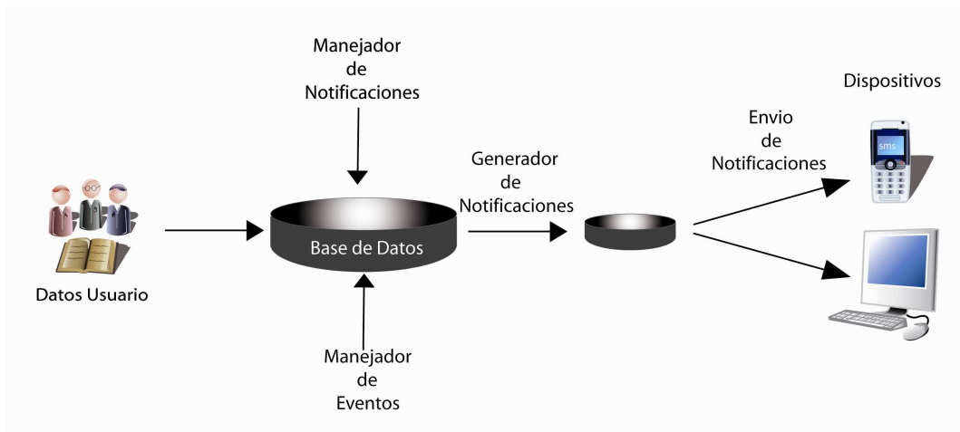
Figura II.1. Arquitectura de la Tecnología de Notificación
