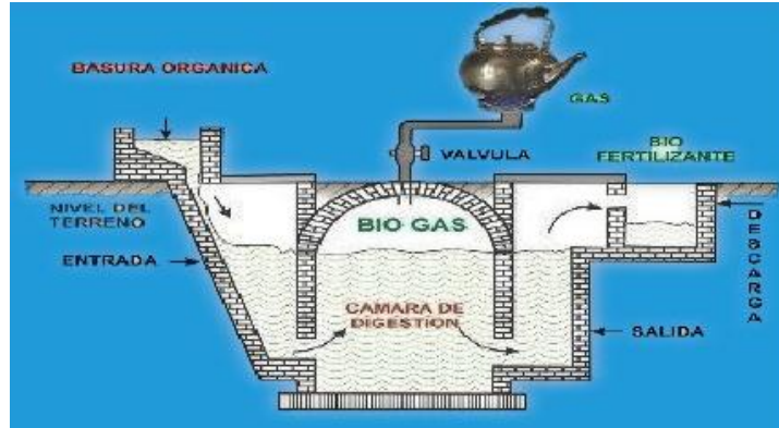
GRÁFICO N° 1. Proceso de biodegradación anaeróbica de materia orgánica.
