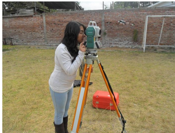
FOTOGRAFÍA No. 5 Levantamiento Topográfico.
