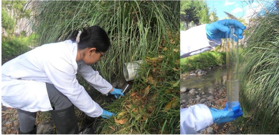
FOTOGRAFÍA No. 10 Medición de caudales mínimos.
