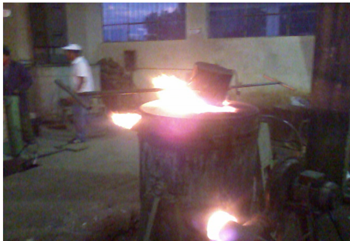
Figura 33. Horno crisol en funcionamiento
