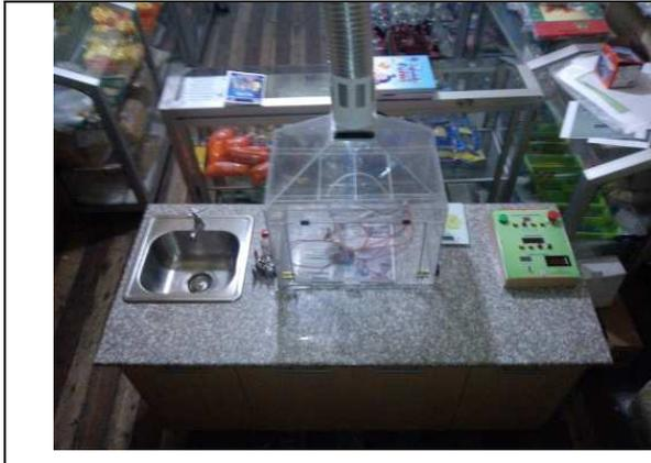
Una vez instalados y realizado el montaje de todos los accesorios se obtuvo el resultado deseado, la mesa de trabajo o planta piloto de tratamientos superficiales.
