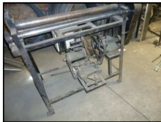
Figura 27: Elementos de transmisión desprotegidos.
