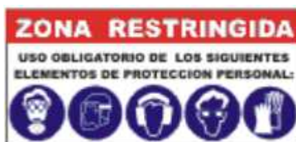
Figura 66: Señal de uso obligatorio de protección personal.
