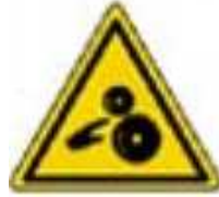
Figura 4: Riesgo mecánico (Aplastamiento)
