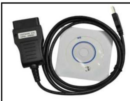
Para dar inicio a la utilización de este programa se localiza el conector DLC y se conecta el conector OBD II al zócalo de autodiagnóstico.
