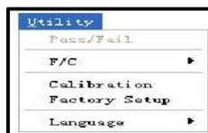
**Calibración.-** La rutina de auto calibración permite optimizar la ruta de señal del osciloscopio para obtener la máxima precisión de la medición. Puede ejecutar la rutina en cualquier momento pero siempre debe realizar la rutina si los cambios de temperatura ambiente de 5 ° o más. A continuación, acceda a la opción - "Utility> Calibración" y siga las instrucciones que aparecen en la pantalla.
